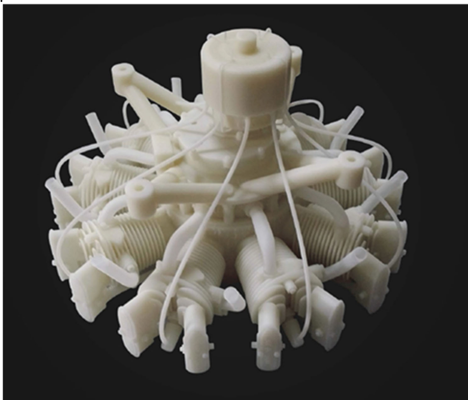
Рисунок 1 – Надрукований на 3D-принтері виріб з фотополімера Formula L1
