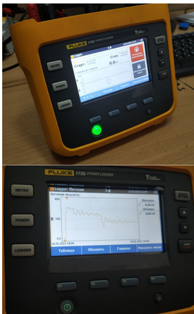
Рис.1. – процес проведення замірів за допомогою FLUKE 1738
