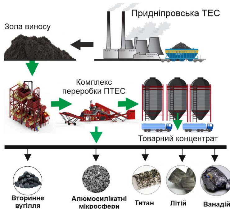
Рис. 1 Технологічна схему комплексної переробки відходів спалювання Придніпровської ТЕС
