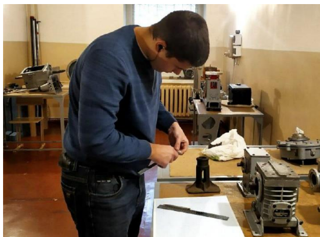
Рис. 1 Зняття розмірів і проведення ескізування
