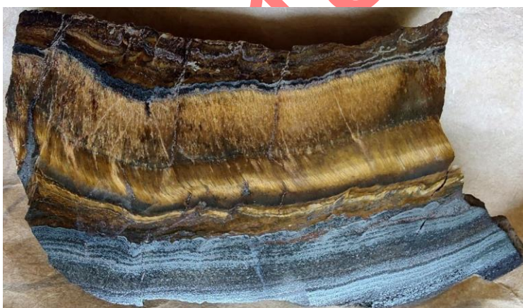
Рисунок 4.1 – Прошарок «тигрового ока» у залізистому кварциті (розмір зразка 50x30 мм)
