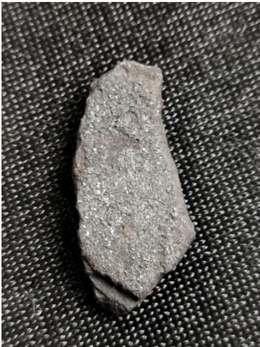
Рисунок 4.5 – Спекулярит (розмір зразка 40 x 20 мм)
