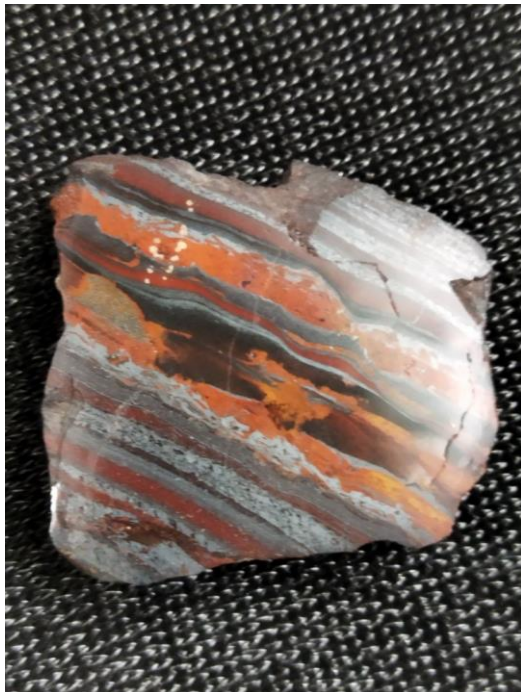
Рисунок 4.3 – Джеспіліт (розмір зразка 45 x 45 мм)
