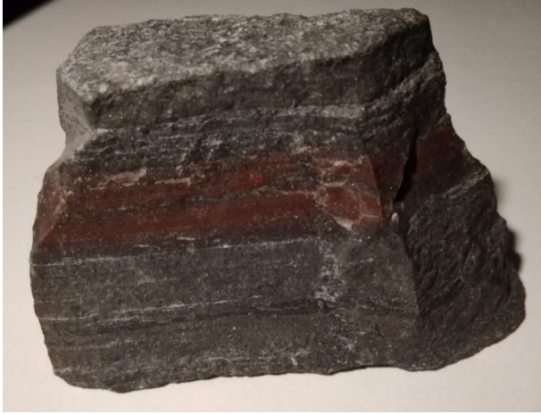
Рисунок 4.4 – Джеспіліт (розмір зразка 55 x 50 мм)
