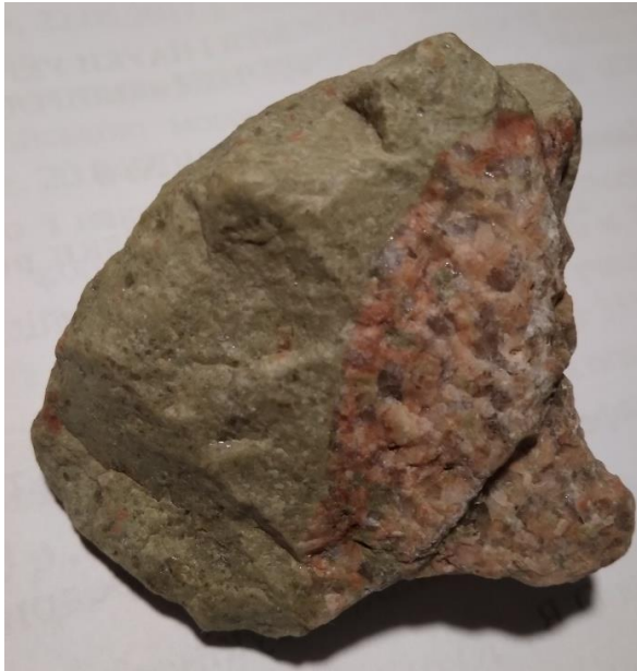
Рисунок 4.8 – Епідозит (розмір зразка 60x60 мм)
