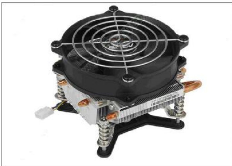
Рис. 1.4. Фотографія радіатора (пристрою охолодження) сучасного мікропроцесора з вентилятором (кулером)
