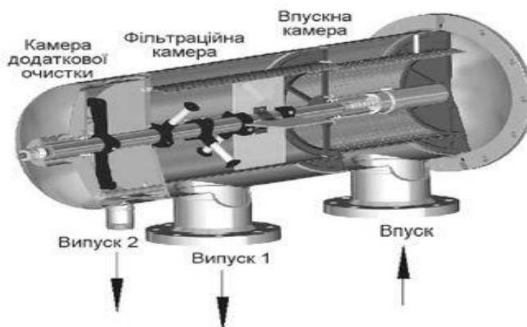
Рисунок 1.2 – Промисловий фільтр для очищення води
