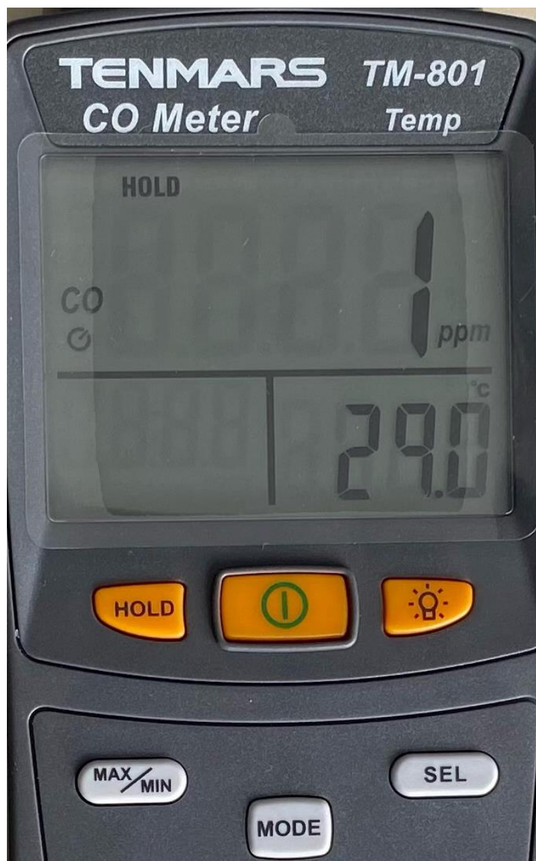
Рис. 1.6. Результати вимірювання концентрації оксиду вуглецю та температури повітря за допомогою газоаналізатора Tenmars TM-801
