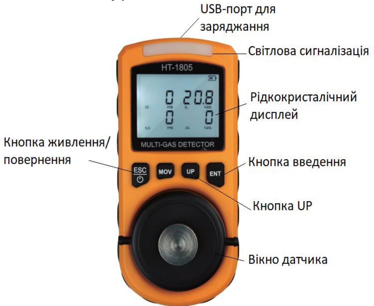
Рис. 3.2. Газовий детектор Walcom HT-1805
