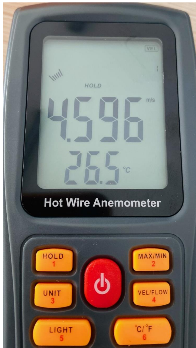
Рис. 4.4. Результати вимірювання швидкості вітру та температури повітря за допомогою термоанемометра Venetech GM8903
