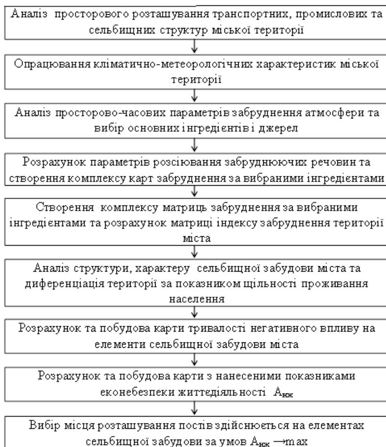
Рис. 2.1 – Алгоритм вибору місць розташування постів міської системи моніторингу атмосферного повітря
