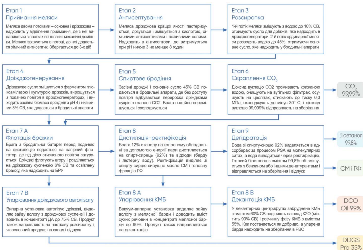
Рисунок 1.5 - 12 основних стадій процесу виробництва біоетанолу з меляси
