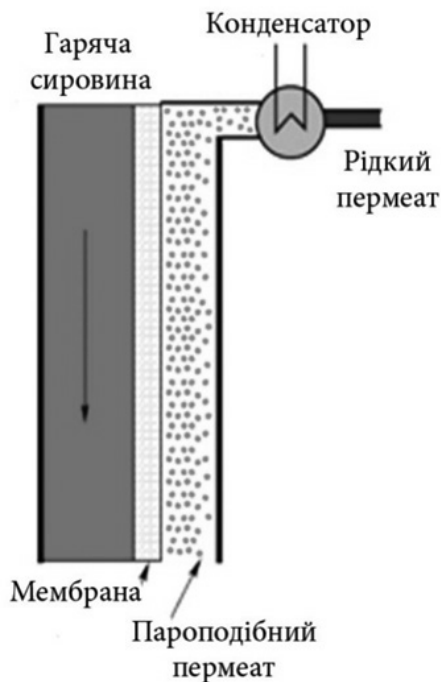
Рисунок 1.10 - Схема мембранної дистиляції зі зниженим тиском (вакуумна)
