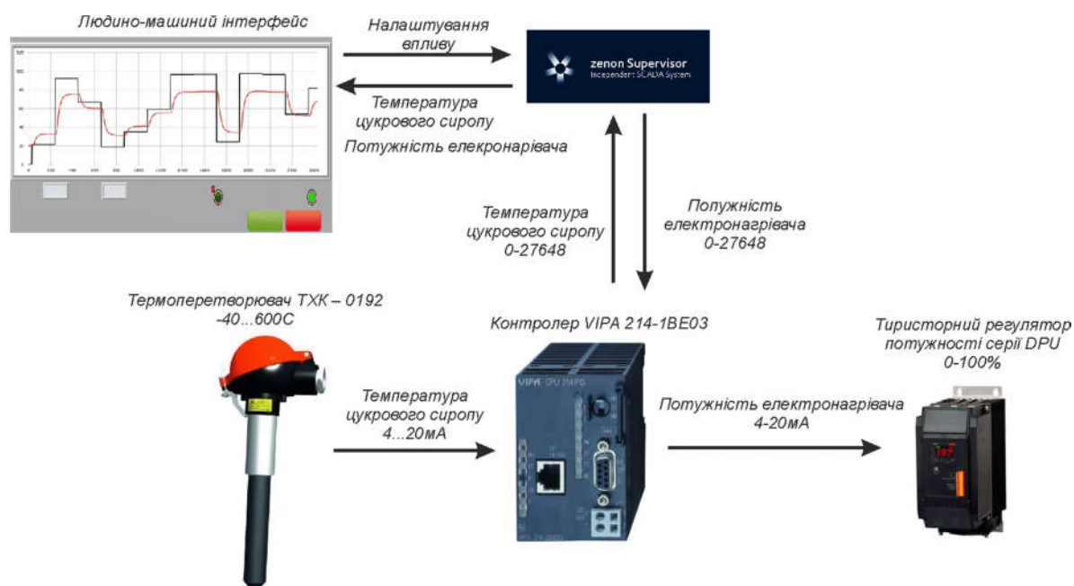
Рисунок 3.1 – Структурна схема інформаційних потоків дослідницької системи
