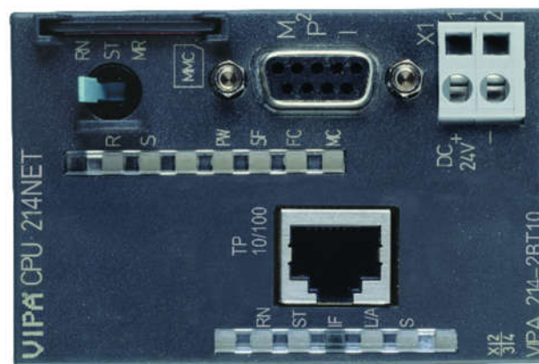
Рисунок 2.4 – Процесорний модуль VIPA 214NET (214-1BT10)
