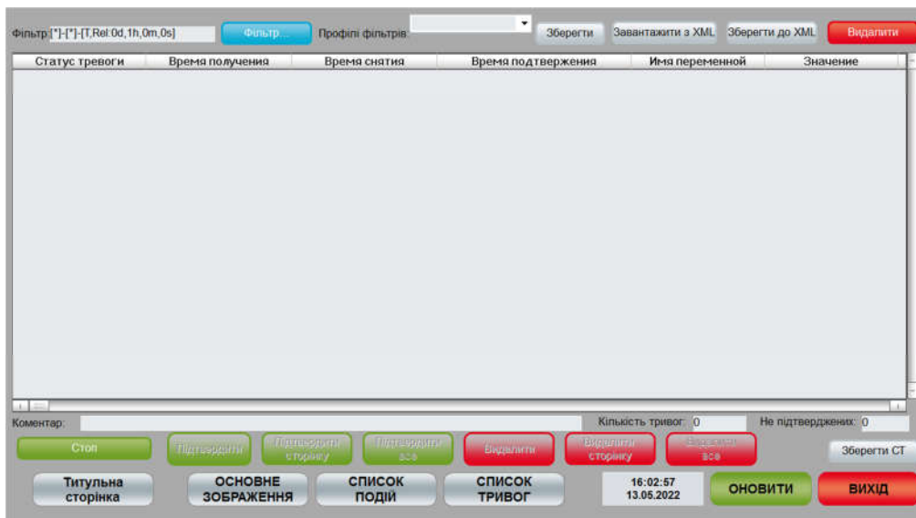
Рисунок 3.9 – Вікно відображення списку тривог системи керування вібропресом
