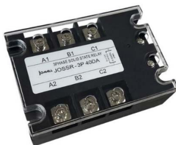
Рисунок 2.7 – Трифазне твердотільне реле Jotta SSR 25DA (3x~380 В, 0...24 В)
