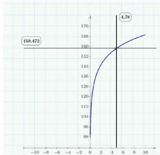
Рисунок 2.6 – До розв'язання нерівності на максимально можливі втрати на трасі від базової станції до абонентської у випадку 3 і 4 частотних каналів у стільнику для моделі COST-231 Hata
