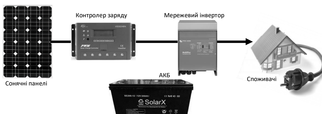
Рис. 2. Схема СЕ автономного типу змінного струму
