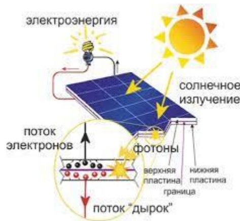
Рисунок 2.9 – Принцип роботи кремнієвого фотоелемента
