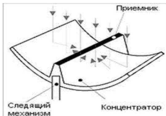
Рисунок 2.6 – Конструкція параболічного модуля
