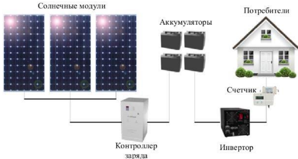
Малюнок 2.13 – Схема автономної роботи СЕС
