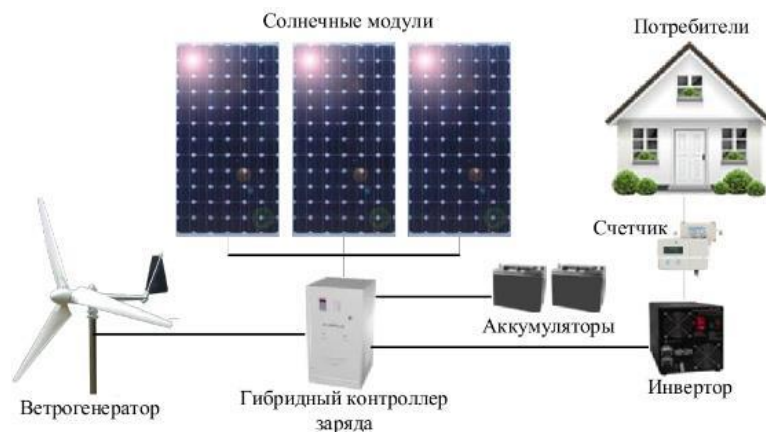
Рисунок 2.20 – Гібридна схема з'єднання
