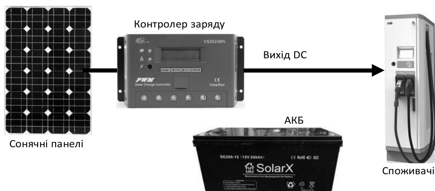
Рис. 1. Схема СЕ автономного типу постійного струму
