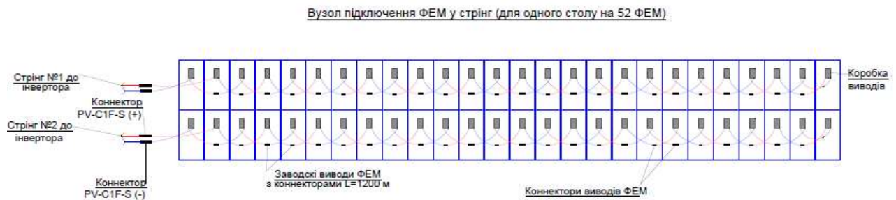
Рисунок 16 – Конструктивне виконання одного столу ФЕМ
