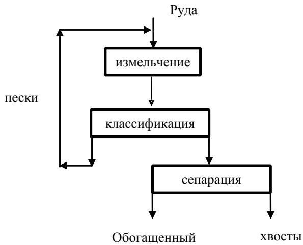
Схема технологического блока обогащения руды
