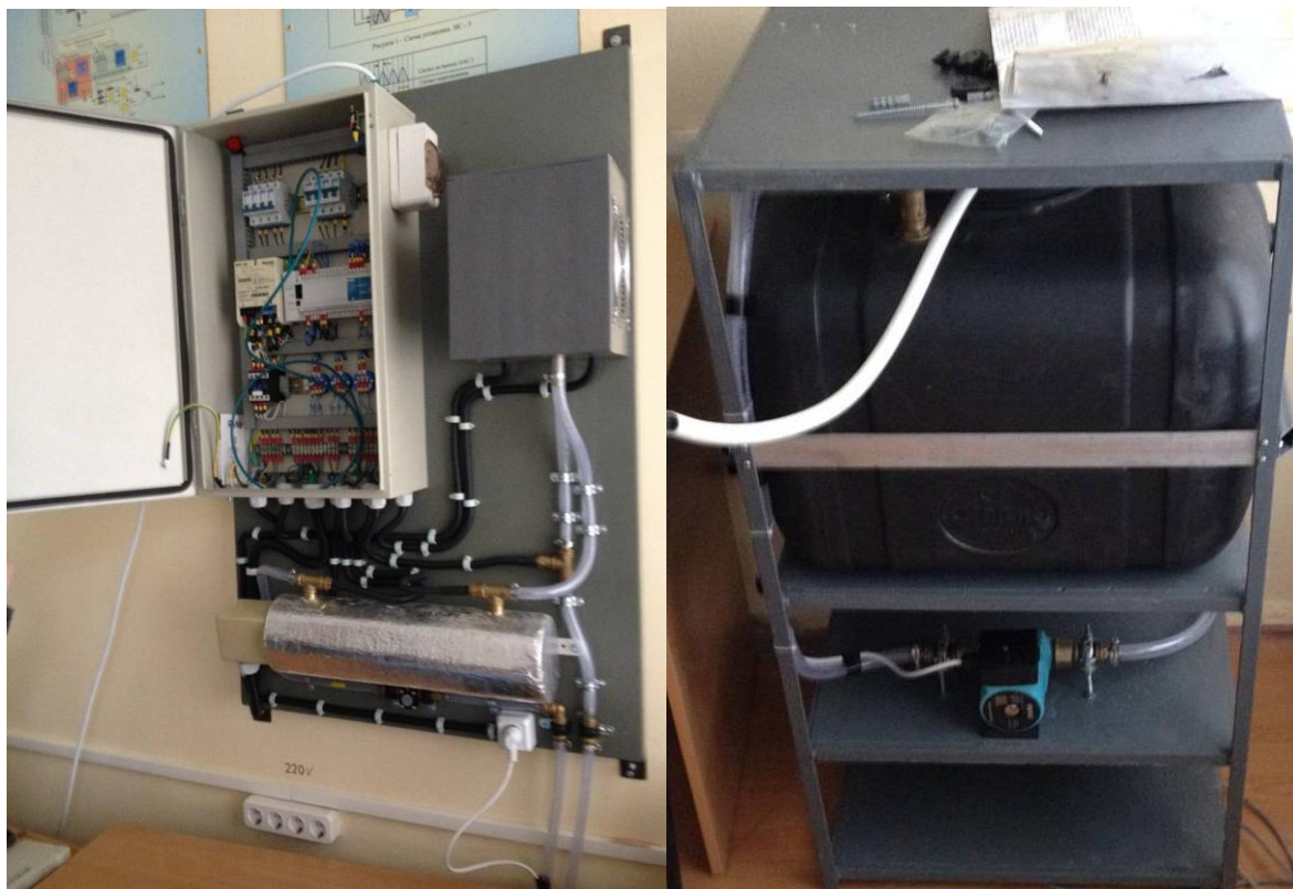
Рис. 1 Загальний вид стану для дослідження питомих енерговитрат проточного нагріву води
