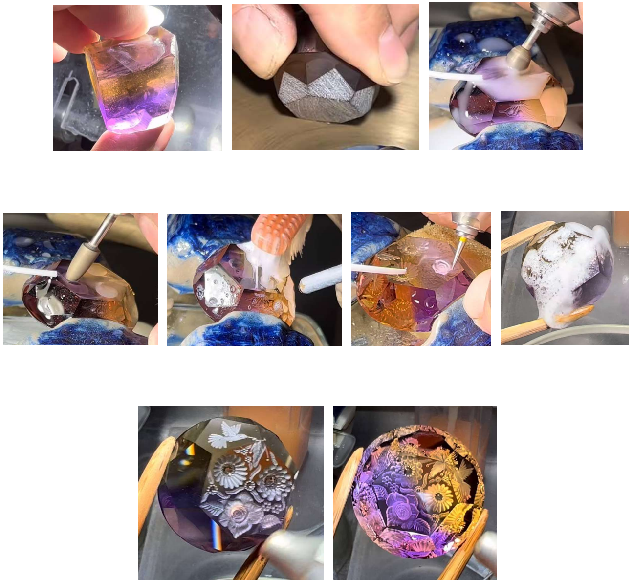
Рис. 3.6. Основні етапи процесу створення фантазійної огранки аметрину [15]
