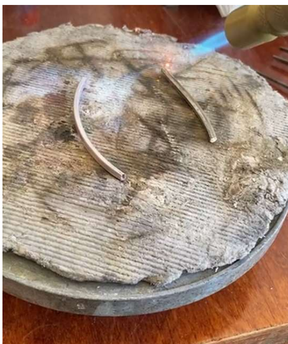
Рис. 3.10 Четвертий етап - формування каблучки
