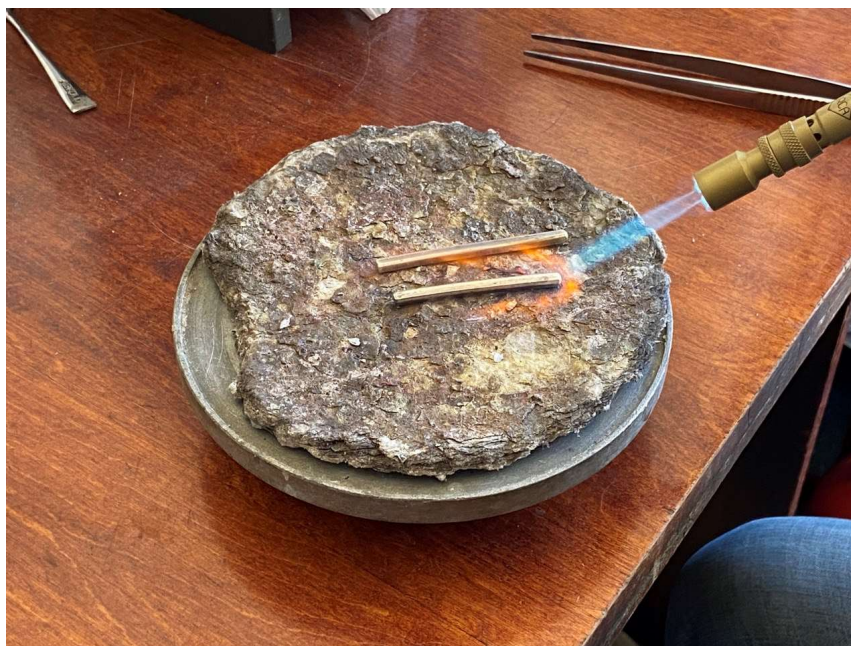
Рис. 3.9 Третій етап - зняття напруги в металі шляхом нагрівання
