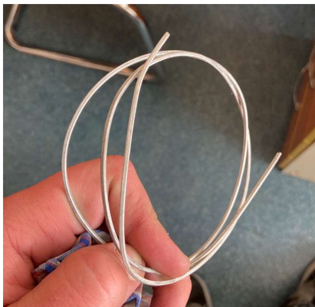
Рис. 3.13. Сьомий етап - вальцювання срібної мотузки
