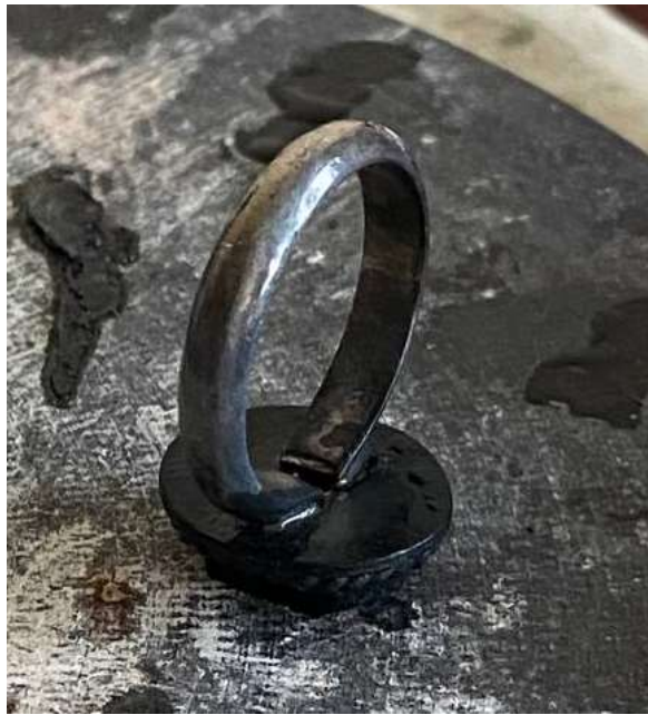
Рис. 3. 15. Дев'ятий етап - пайка готової пластини з кастом і перстнем
