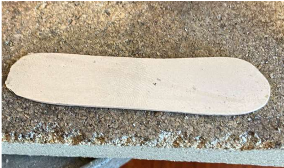
Рис. 3.11 П'ятий етап - формування пластини і касту
