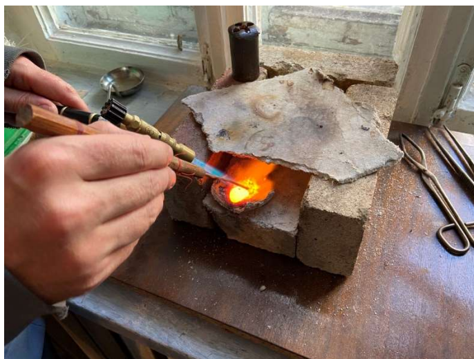
Рис. 3.7. Перший етап – плавка срібла
