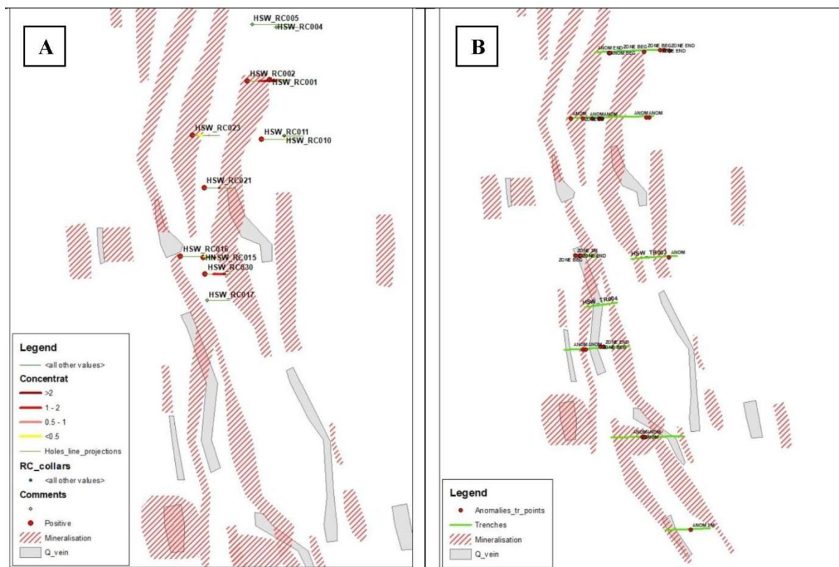
Рисунок 2 – Схема інтерпретації геофізичних даних з результатами буріння А та проходки каналів В.
