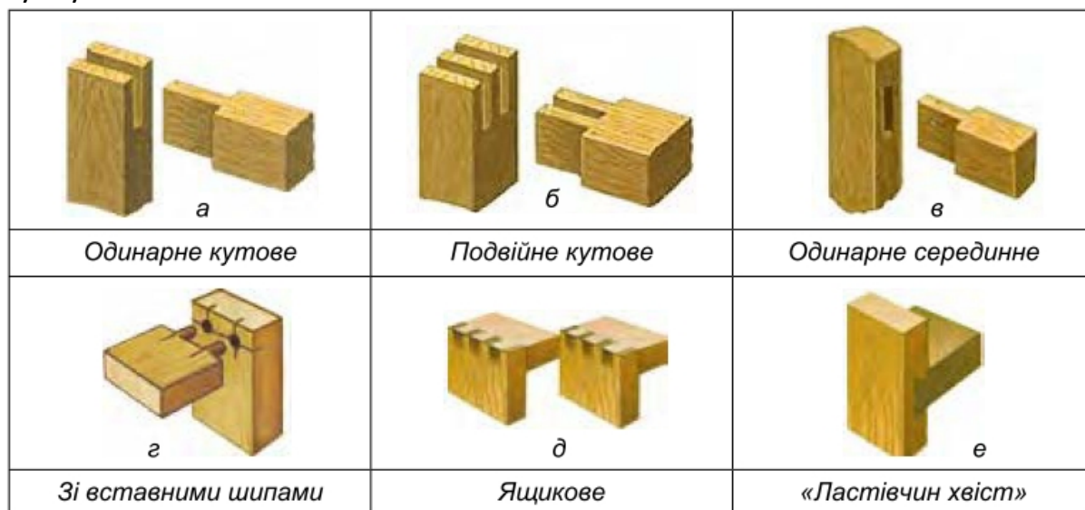
Рис. 1. – Різновиди шипових з'єднань
