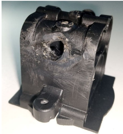
Рис. 1. – Пошкодження кришки насосу
