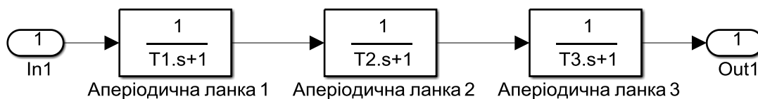
Рисунок 3.6 – Структурна схема лінеаризованої САК положенням засувки у живильному трубопроводі деаератора (три аперіодичні ланки)
