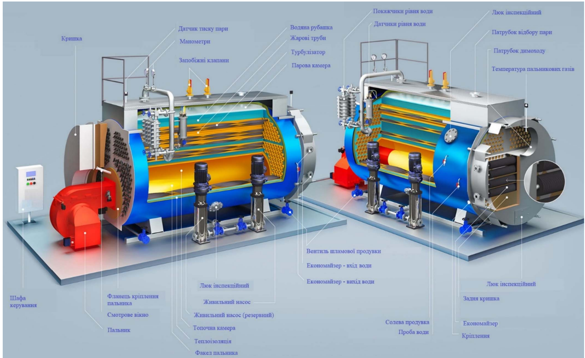
Рисунок 1.11 – Конструктивні особливості парових котлів серії MEP-0
