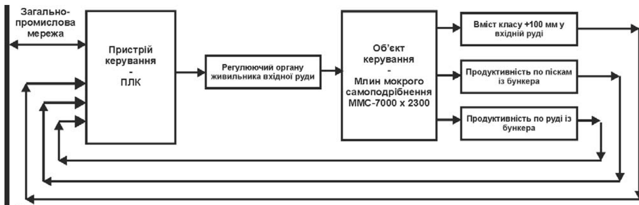
Рисунок 2.1 – Структура системи керування млином мокрого самоподрібнення MMC-7 000 x 2 300
