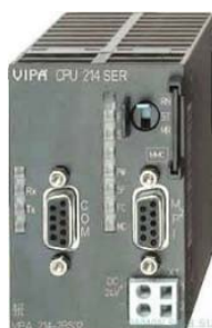
Рисунок 2.5 – Програмований логічний контролер VIPA 214-2BS33
