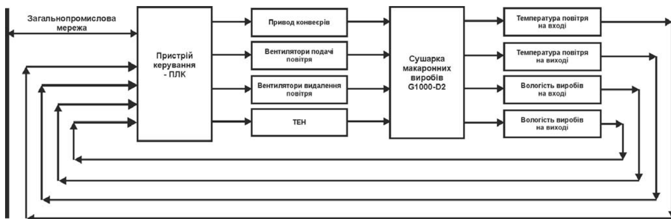
Рисунок 2.1 – Структурна схема системи керування
