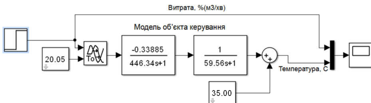
Рисунок 3.16 – Модель Simulink об'єкта керування
