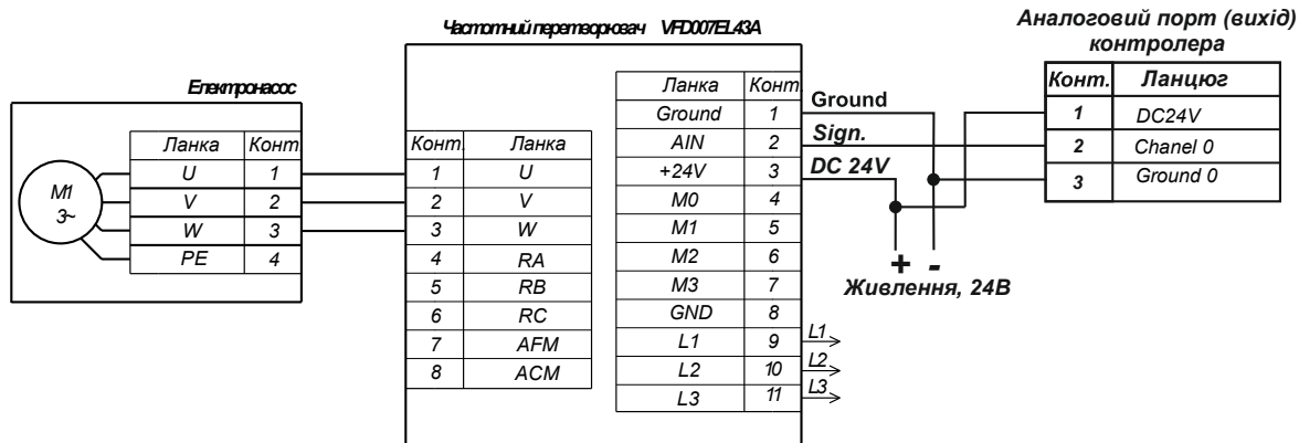
Рисунок 2.7 – Схема підключення частотного перетворювача до контролера
