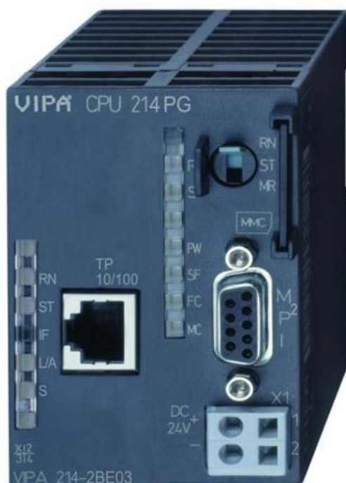
Рисунок 2.3 – Вигляд модуля мікропроцесорного контролера 214-2BE03 Технічні характеристики контролера наведені в таблиці 2.2.
