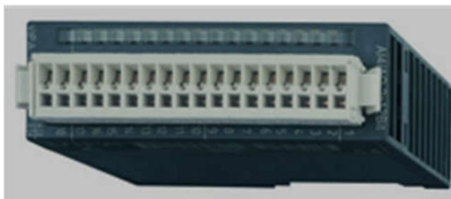
Рисунок 2.7 – Модуль аналогового вводу/виводу VIPA 234-1BD60
