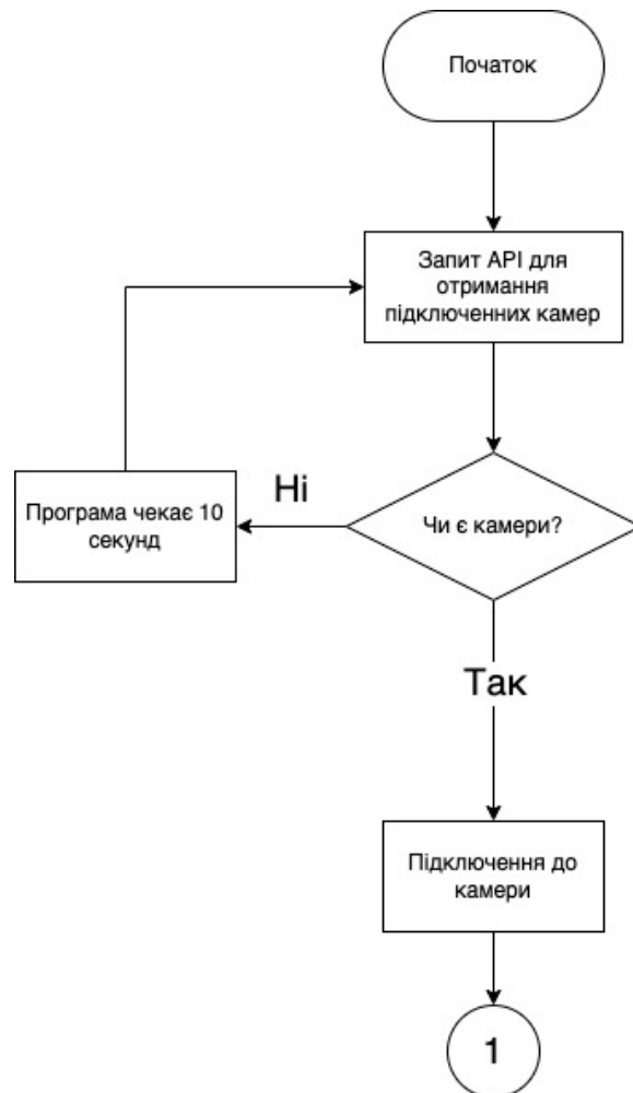
Рисунок 4.1 – Схема алгоритму обробки запитів клієнта (частина перша)
