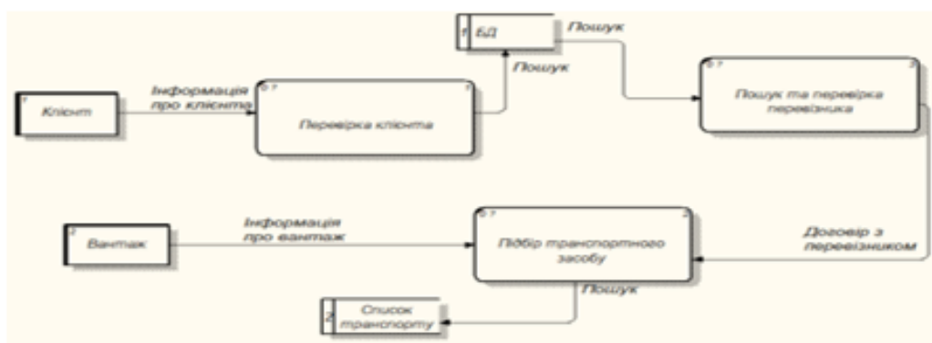
Рис.2 – DFD діаграма «Аналіз замовлення»
