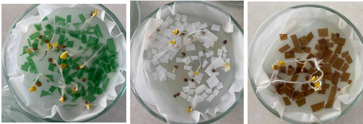
Рисунок 1.2 – Результати ростового тесту на вторинному ПЕТФ
