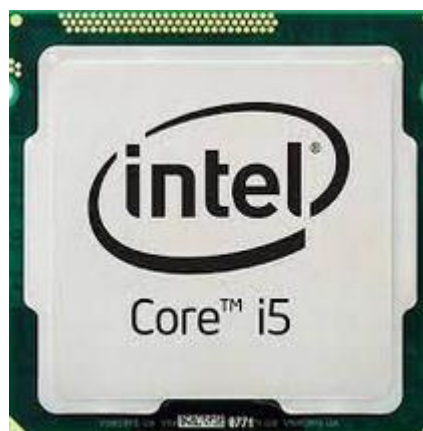
Рис. 2.7. Зовнішній вигляд процесора типу Intel Core i5
