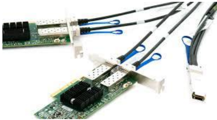
Рис. 2.12. Зовнішній вигляд з'єднання інтегрованих двоспрямованих мережевих інтерфейсів з адаптерами master -вузла та slave -вузлів
