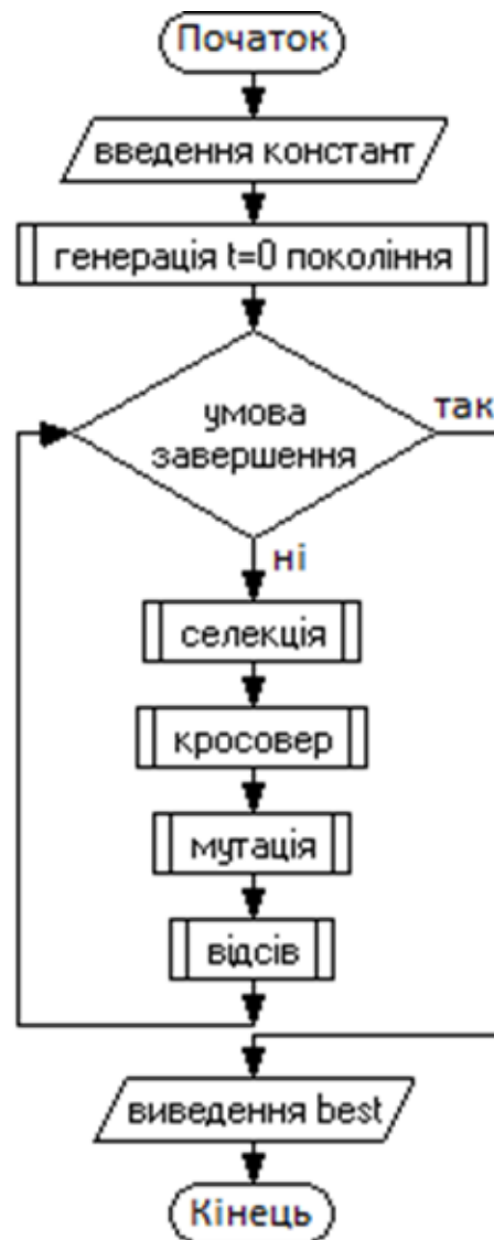
Рис. 1.7. Блок-схема класичного генетичного алгоритму
