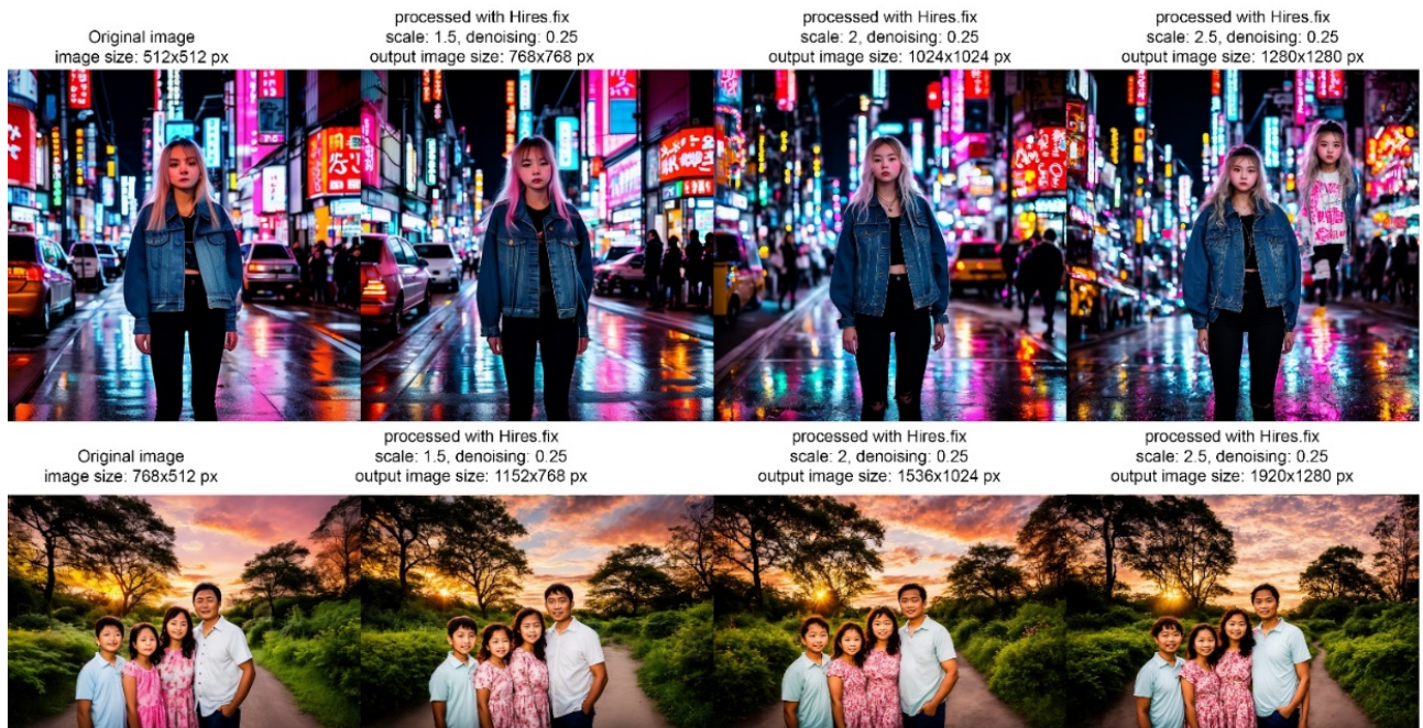
Рис. 3.26. Порівняння якості та структури оригінального зображення та цього ж зображення після підвищення роздільної здатності у 1.5, 2 та 2.5 разів
