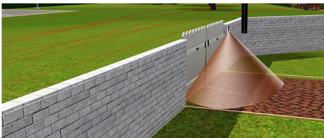
Рис. 2.2. – Об'єкт охорони, оснащений пасивною (вхід до воріт) та активною (на огорожі) інфрачервоною системою охорони периметру.
