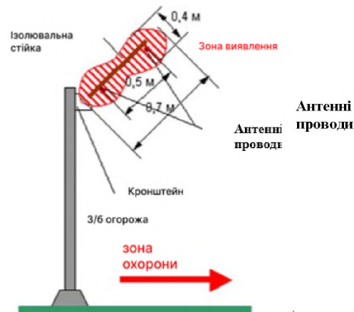
Рис. 1.7 – Принцип роботи ємнісної системи охорони периметру
