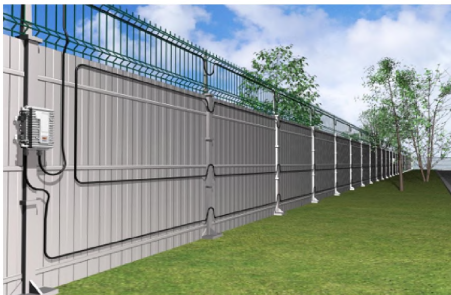
Рис.1.8 – Приклад захисту вібраційною системою охорони
