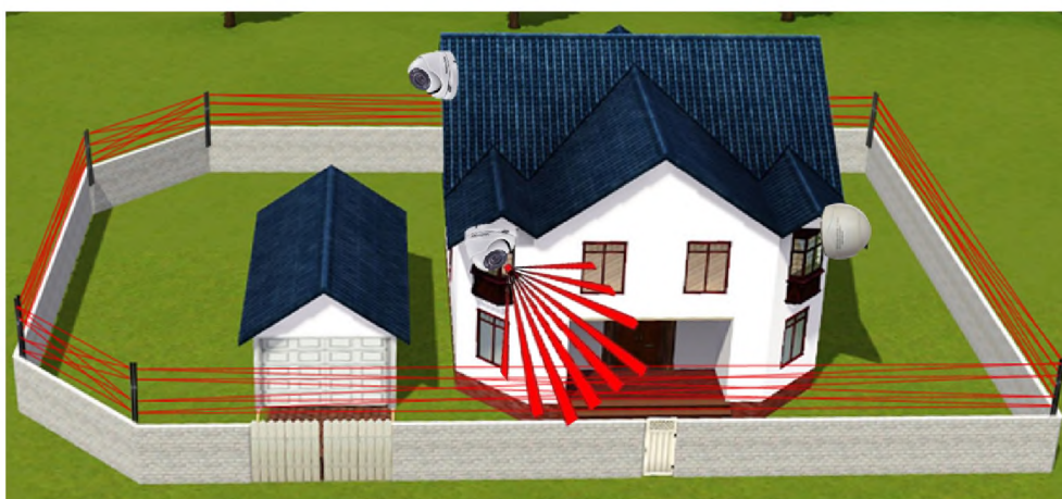
Рис. 2.1. – Об'єкт охорони, оснащений активною інфрачервоною системою охорони периметру та комплектом відеокамер з інфрачервоними датчиками руху
