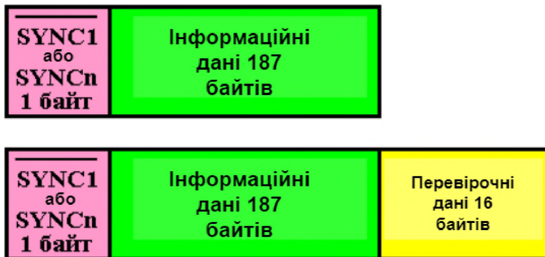
Рисунок 1.7 – Формування пакетів даних із захистом від помилок із пам'яттю зовнішнього коду Ріда-Соломона RS (204, 188)
