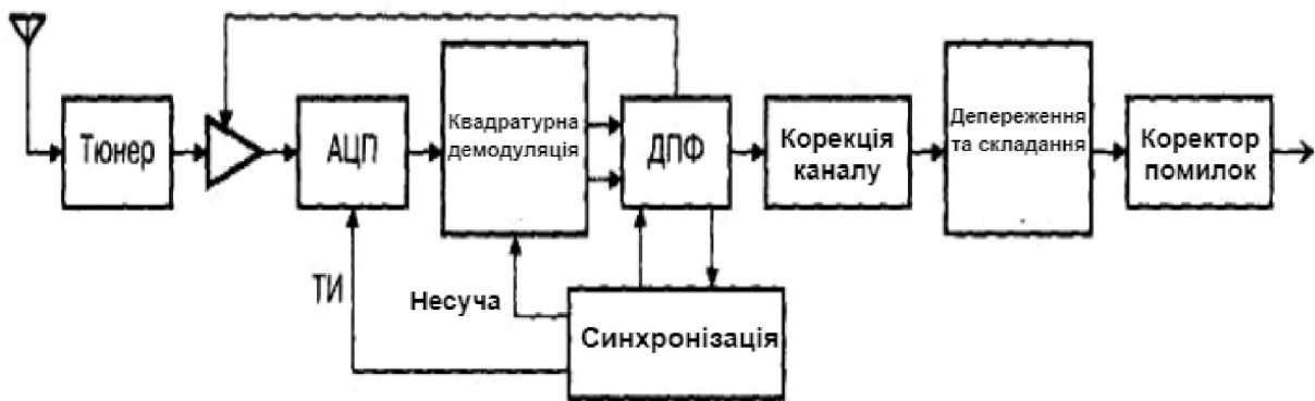
Рисунок 1.4 – Структурна схема приймального тракту у стандарті DVB-T
