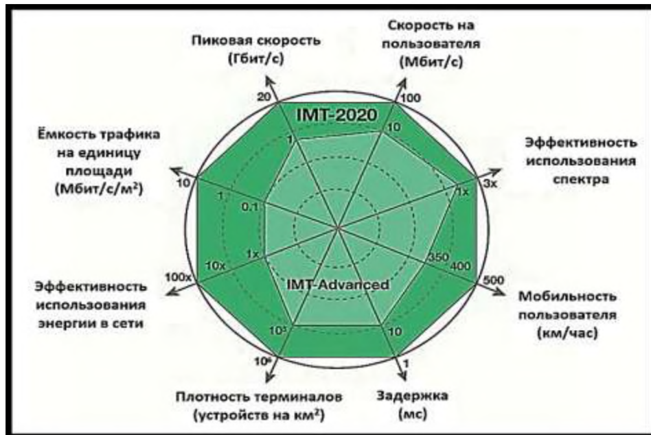
Рисунок 1.6 - Порівняння характеристик мереж 4G та 5G
