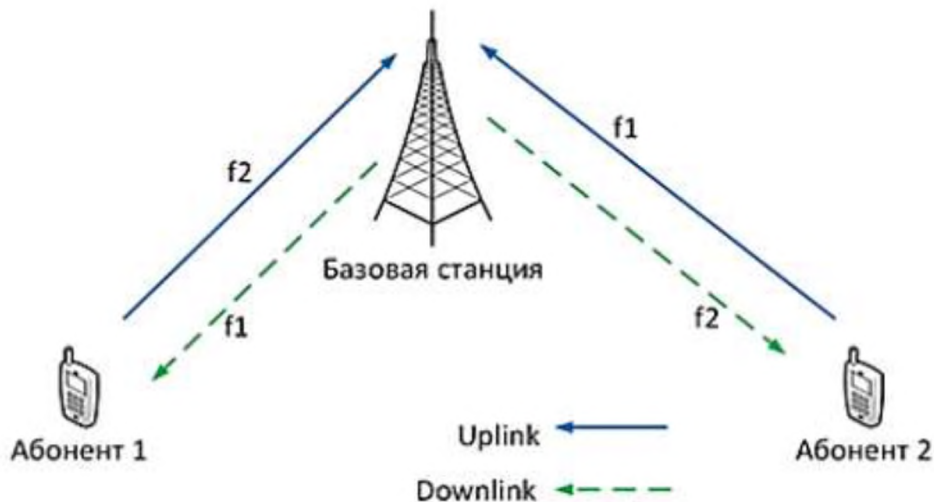
Рисунок 1.20 – Новий принцип роботи повного дуплексу Rysunok 2.5 – Novyy
