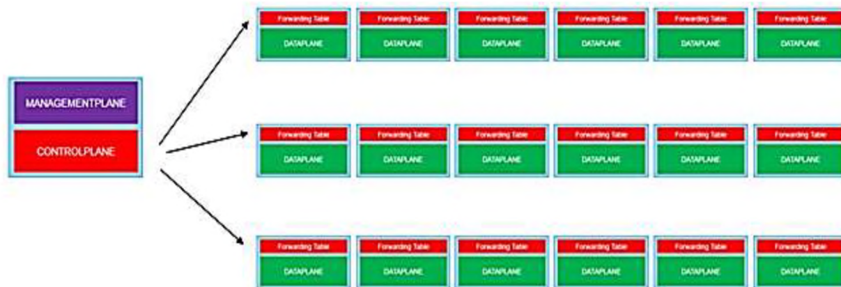
Рисунок 1.29 – Логічна модель мережевих пристроїв SDN
