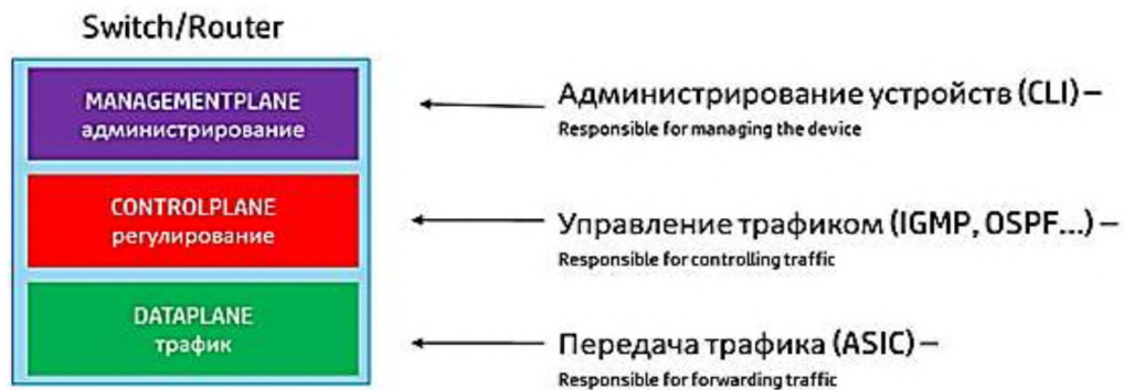
Рисунок 1.28 – Логічна структура мобільних та мережевих пристроїв
