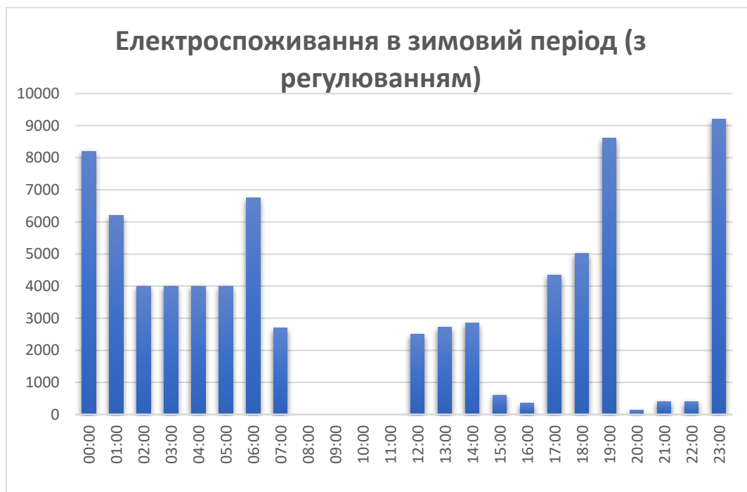
Рисунок 2.9.4 – Графік електричних навантажень приватного будинку в зимовий період при регульованому електроспоживанні.
