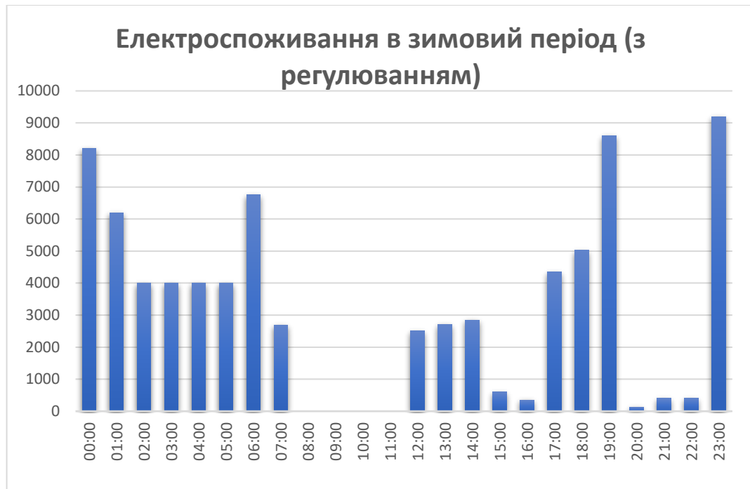
Рисунок 3.5.2 – Графік електричних навантажень приватного будинку в зимовий період при регульованому електроспоживанні.
