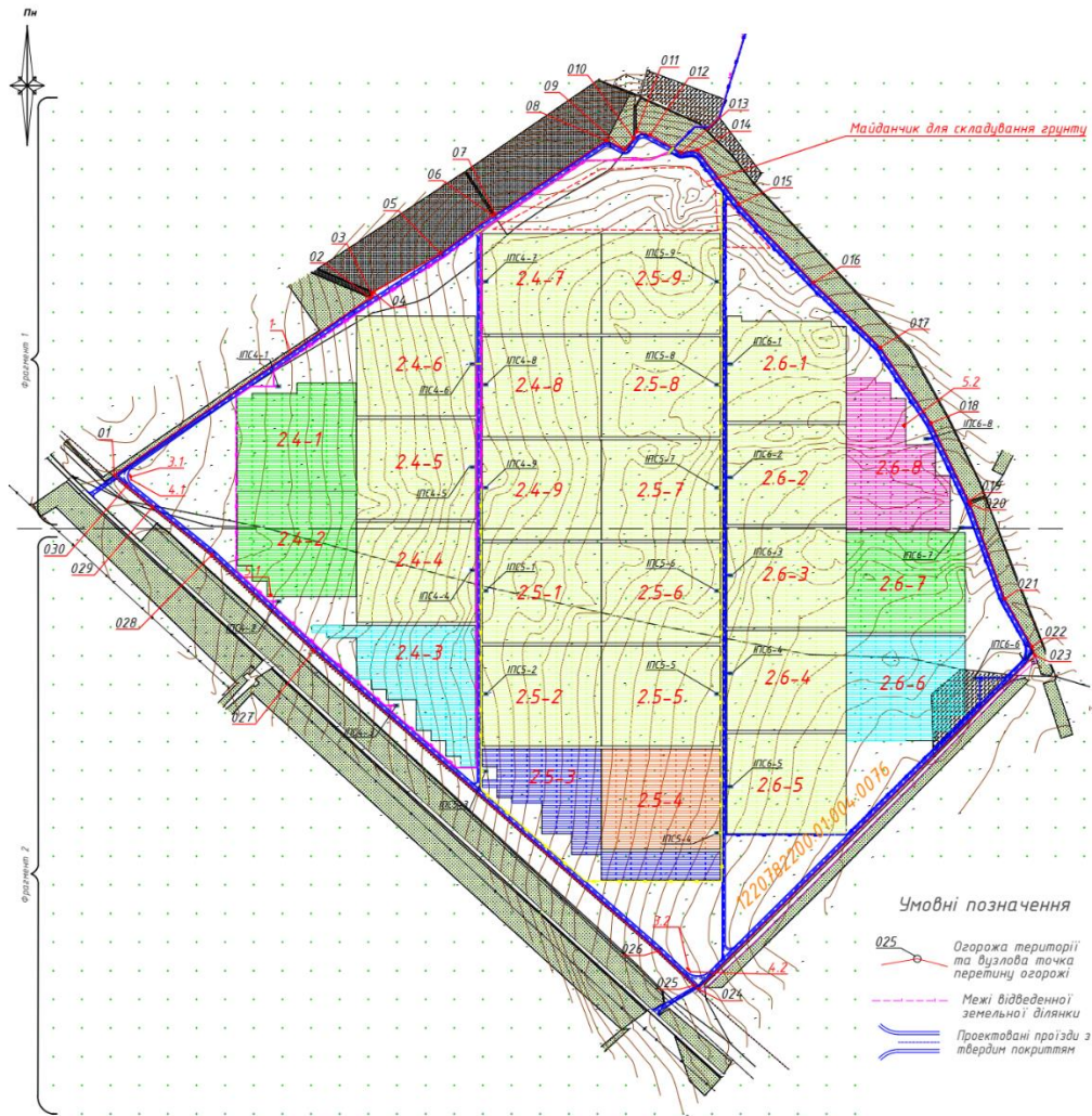
Рисунок 1.4 - Генплан розташування полів фотомодулей та інверторних підстанцій Ділянки №2 Васильківської СЕС
