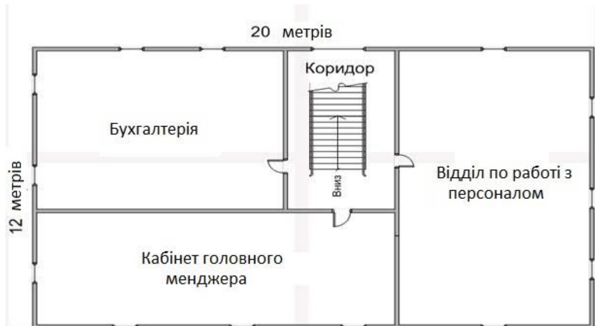
Рисунок 1.3 – Генеральний план 2 поверху офісної будівлі
