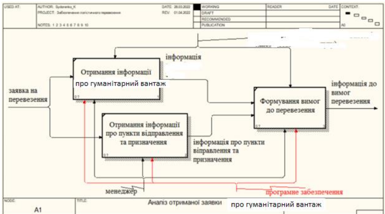
Рисунок 1.5 – Декомпозиція 1-го «Аналіз отриманої заявки» у стандарті IDEF0 бізнес-процесу «Забезпечення логістичних перевезень гуманітарних вантажів»
