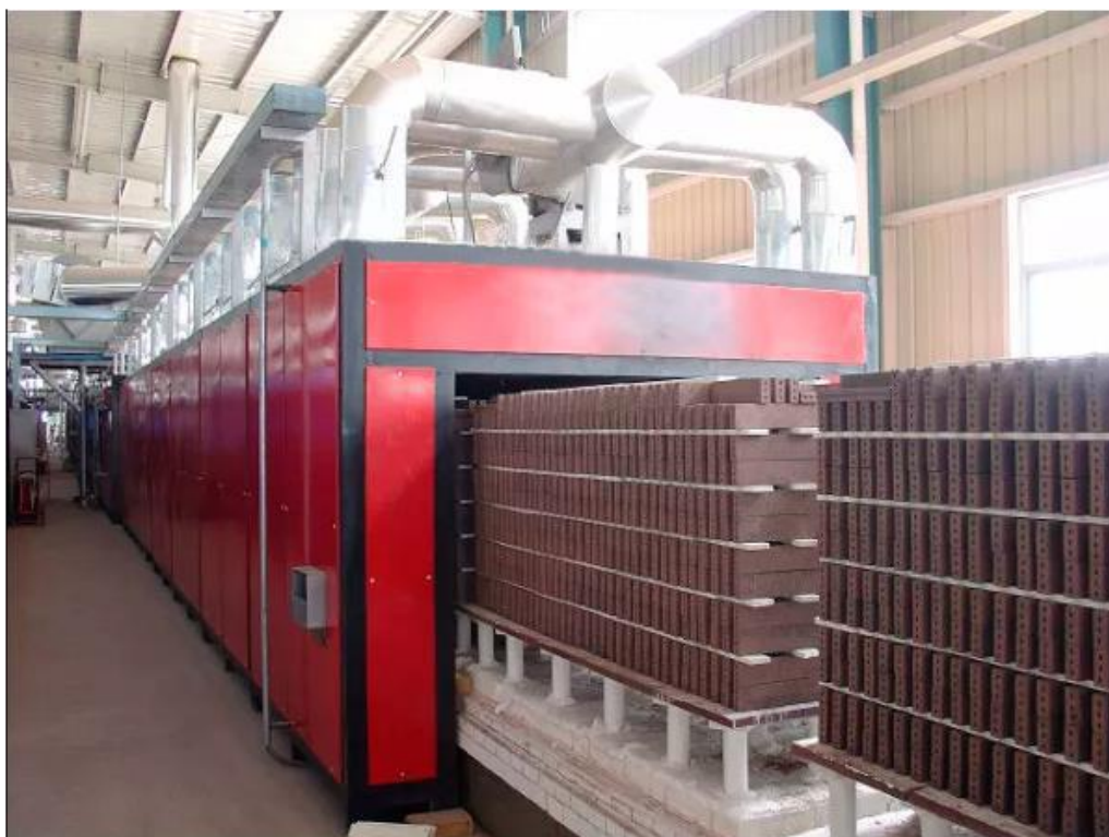
Рисунок 1.6 – Зовнішній вигляд тунельної печі для випалювання керамічних виробів
