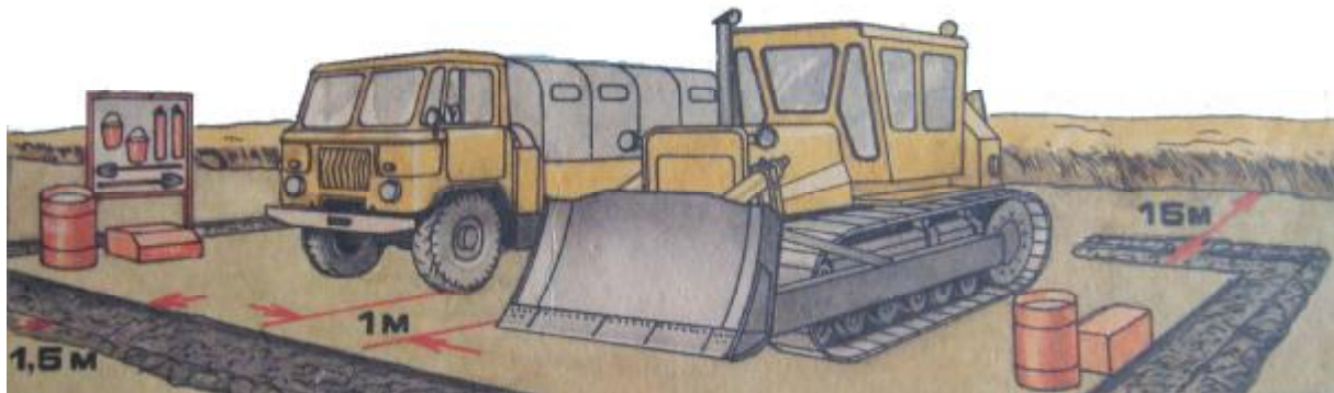
Рис. 5.6. Протипожежне обладнання стоянки транспорту
