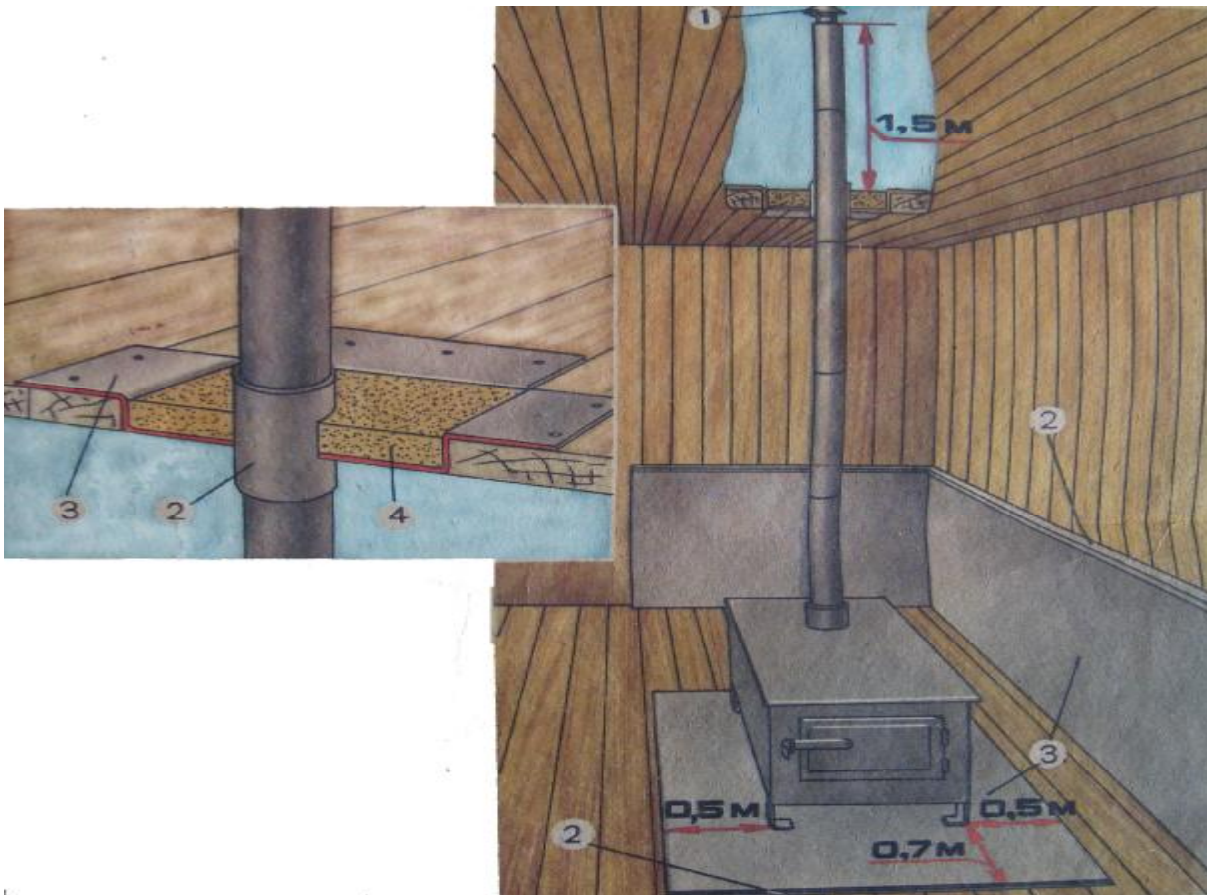
Рис. 5.8. Протипожежне облаштування печі: 1 – іскрогасник, 2 – азбест, 3 – металевий лист, 4 – негорючий матеріал
