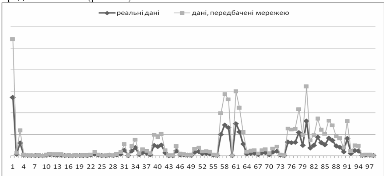
Рис. 3.5. Результат навчання нейронної мережі – порівняння реальних даних та відгуку мережі
