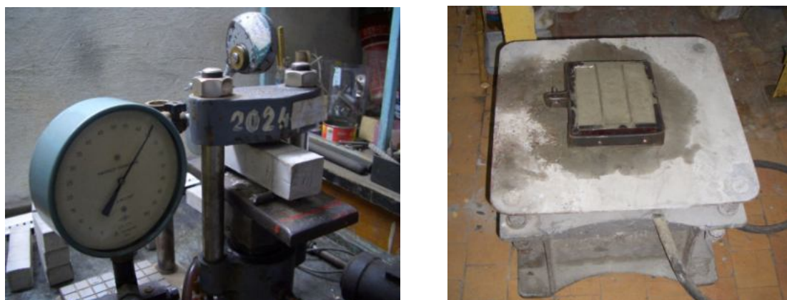
Рис. 1 Испытание фибробетонных образцов
