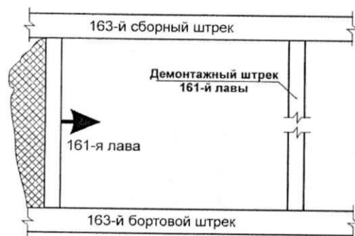
Рис. 1. Схема расположения демонтажного штрека 161-й лавы
