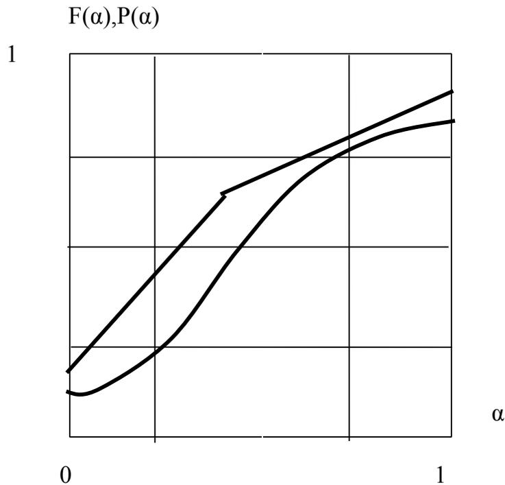
Рис. 1. Сепарационная характеристика аппарата и функция распределения сродков
