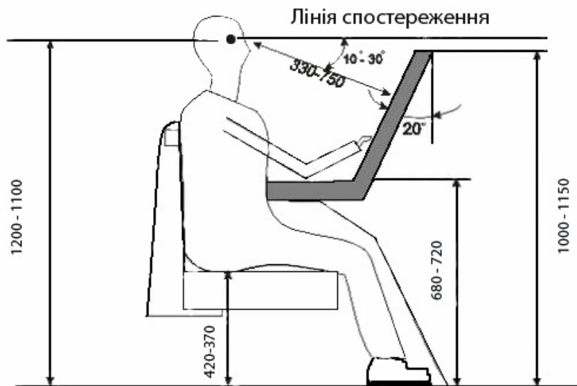
Рис. 7.11. Схематичне зображення пульта оператора
