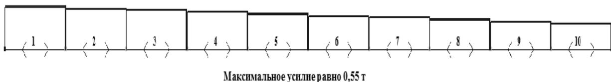
Рис. 2 - Нормальные усилия, возникшие в бетонной части балочки из композитного материала при ее нагреве до +40<sup>o</sup>С.
