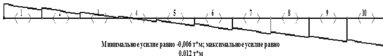
Рис. 5 - Нормальные усилия, возникшие в бетонной части балочки из композитного материала при ее охлаждении до  $-2^{\circ}\text{C}$ .
